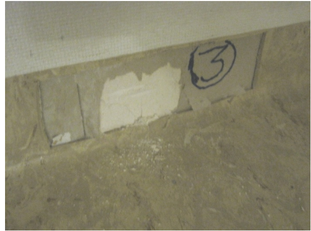
Foto 1: Prøve 3 av vinylbelegg i korridor viser innhold av mindre mengder tungmetaller og ftalater over grense for farlig avfall.
