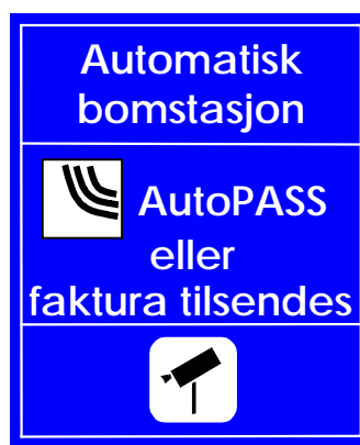
Figur 1. Opplysningsstavle (200-400 m før bomstasjon)
