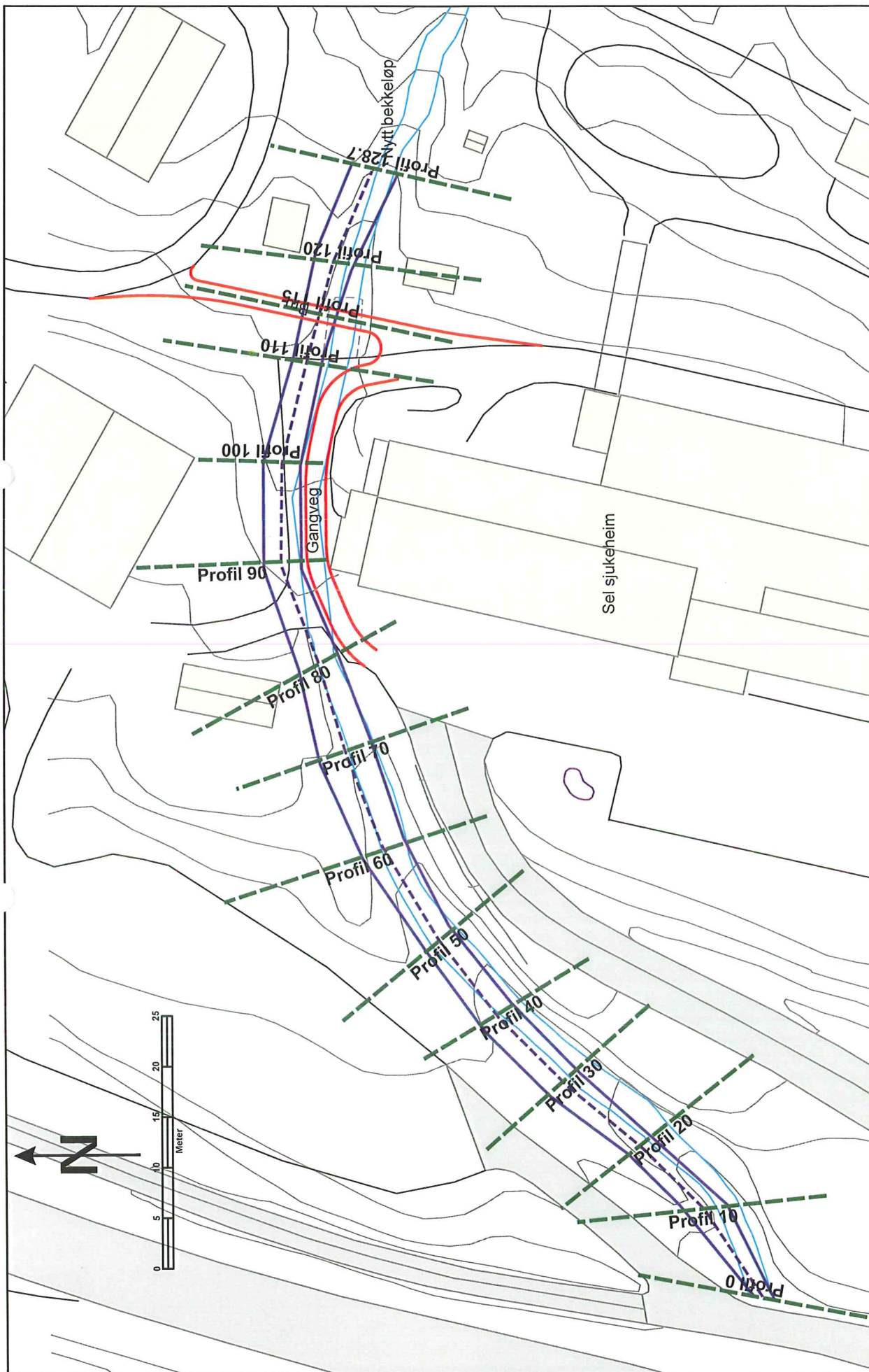
Forbygging av Haredalsåa ved Sel sjukeheim. Situasjonskart med bekkeløp, ny gangveg og gangbru. Solvang og Fredheim Gudbrandsdalen AS 01.10.2012. Målestokk 1:500. Ekvidistanse 1 m.
