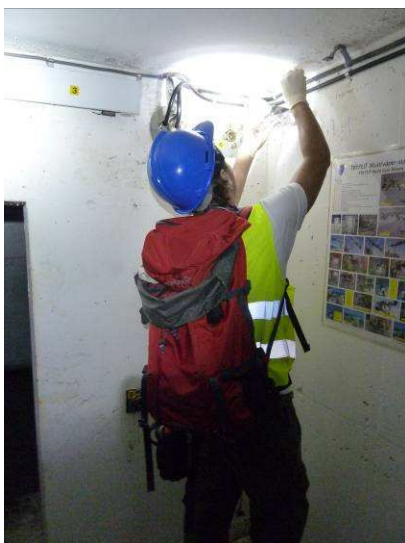
Bilde 42 viser prøvetaking av hvitmaling fra tak og vegger i inventar 1028 i Kitdalen.
