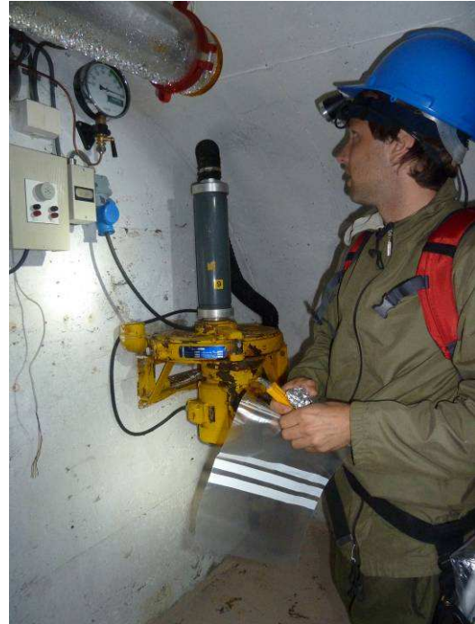
Bilde 47 viser prøvetaking av hvitmaling fra vegg inne i inventar 1002 Oteren.
