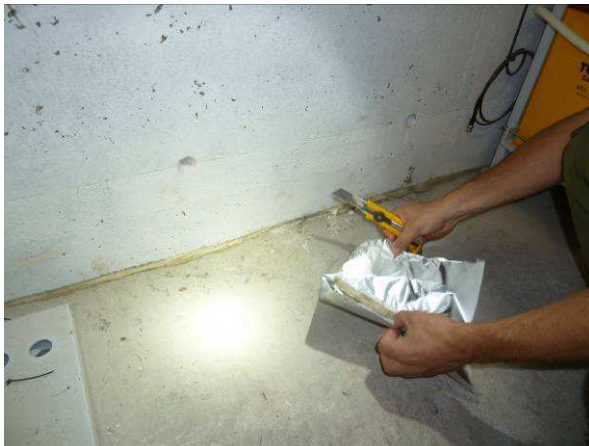
Bilde 39 viser prøvetaking av myk fuge mellom betonggulv og betongvegg i et dekningsrom i Skibotn. Fugen inneholder ikke klorparafiner
