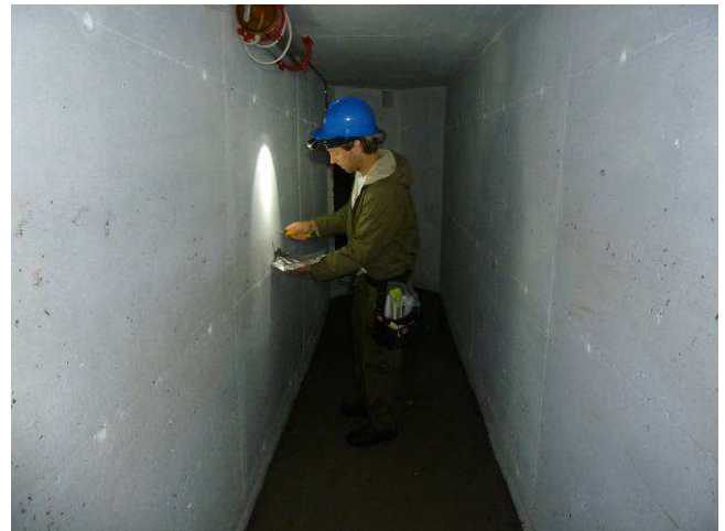
Bilde 48 viser prøvetaking av hvitmalt vegger i inventar 1006 Oteren.
