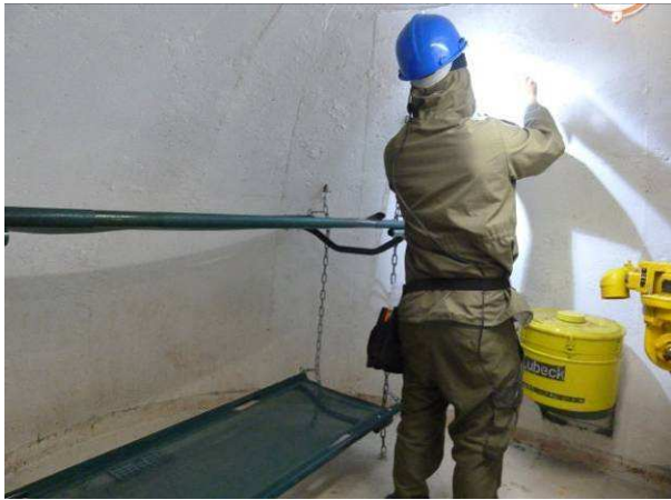
Bilde 49 viser prøvetaking av hvitmalte vegger og tak i inventar 1007 Oteren.
