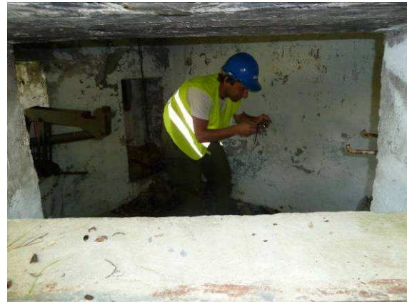
Bilde 43 viser prøvetaking av hvitmaling inne i inventar 0033 i Skibotn. Blokkhus for mitr./Mg.
