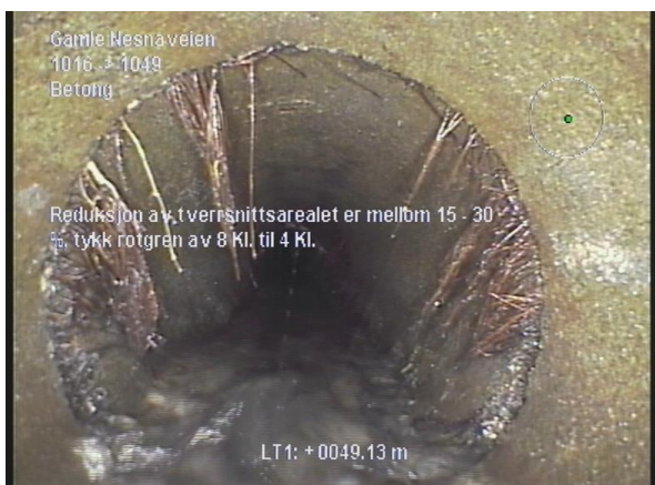
14.11.2024 150201_1016_1049_14112024_030307_050.jpg, 00:05:50, 49.10m Reduksjon av tverrsnittsarealet er mellom 15 - 30 %, tykk rotgren av 8 Kl. til 4 Kl.
