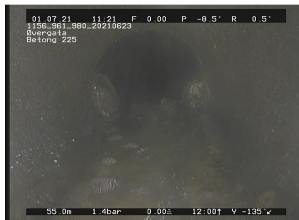
10, 00:09:07, 55.00m Utfelling/Belegg, reduksjon i tverrsnittsarealet er 5% eller mindre, av 3 Kl. til 9 Kl., Utfelling
