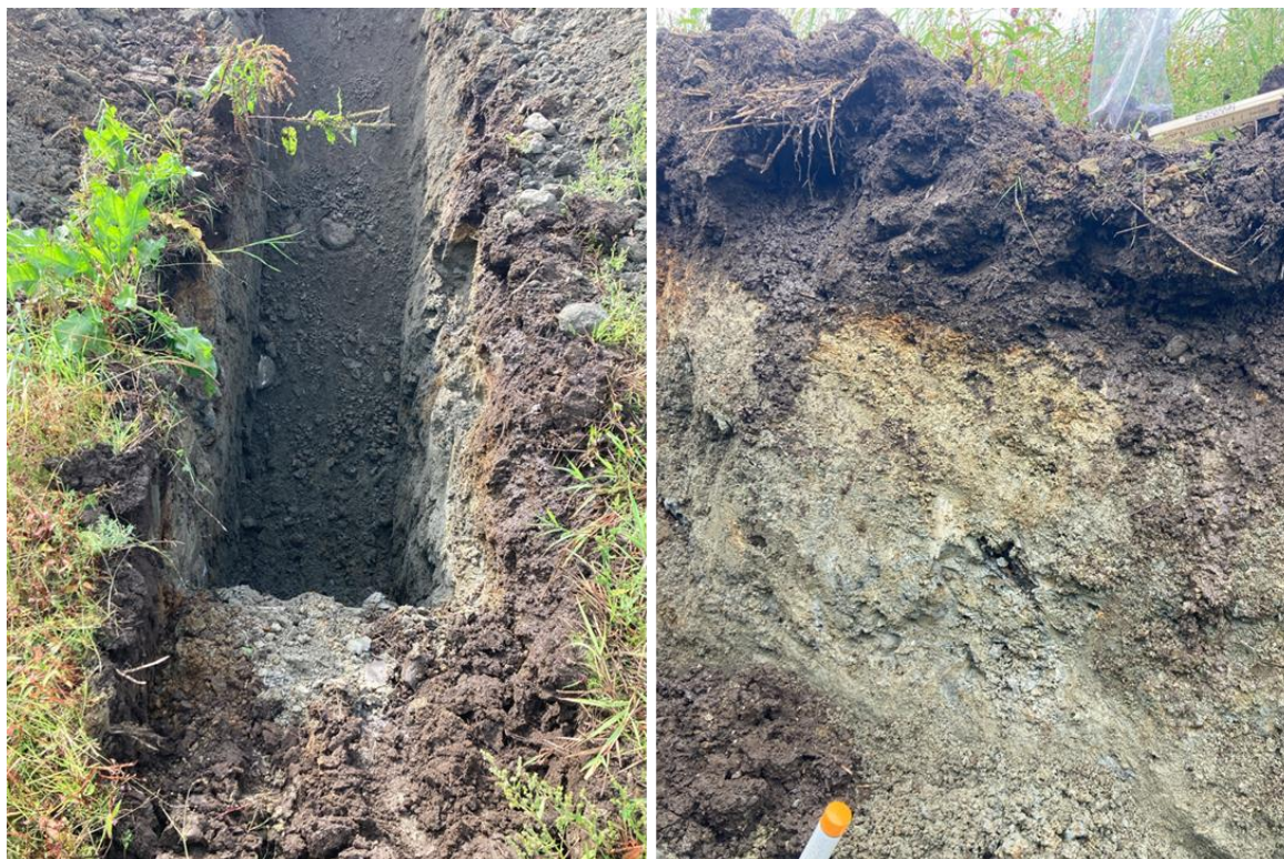
Figur 5 Gravesjakt i prøvepunkt P3. Tydelig sjiktinndeling hvor øvre 30 cm består av matjord og underliggende masser består av siltig sand og stein
