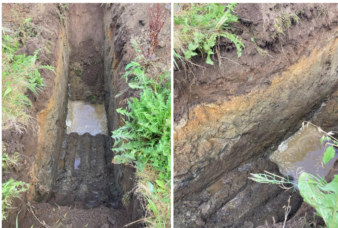
Figur 6 Gravesjakt i prøvepunkt P4. Tydelig sjikt deling mellom matjord i overflaten og kompakte masser under. Vanninnsig i sjakt og mye stein (fyllitt).
