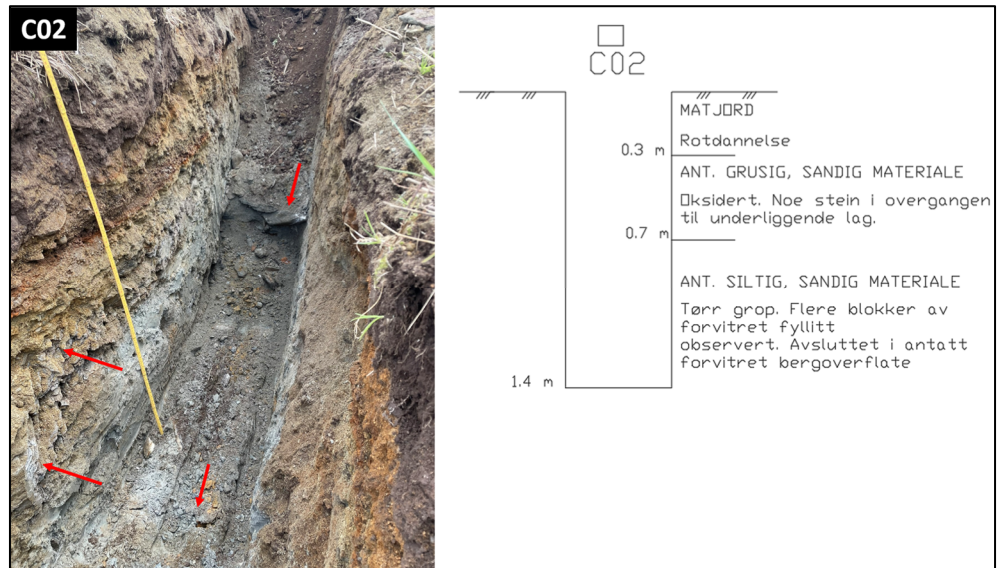
Figur 11: Fotografi grop C02 med tolket lagdeling. Antatt forvitret bergoverflate av fyllitt i bunn ved ca. 1,4 m under terreng. Tørr grop. Pilene indikerer flere blokker av bestående av fyllitt med høy forvitningsgrad.
