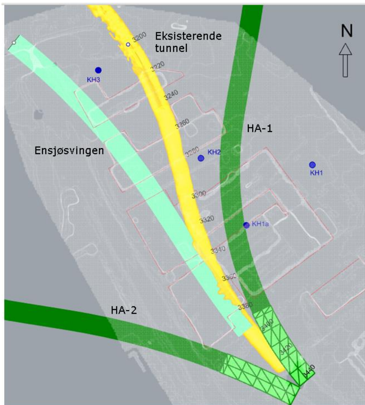
Figur 1: Eksisterende T-banetunnel (gul) og mulige fremtidige T-banetunneler (grønn og turkis). Blå sirkel viser plassering av kjerne hullene for kjerneboringer. Utklipp fra 3D-modell.
