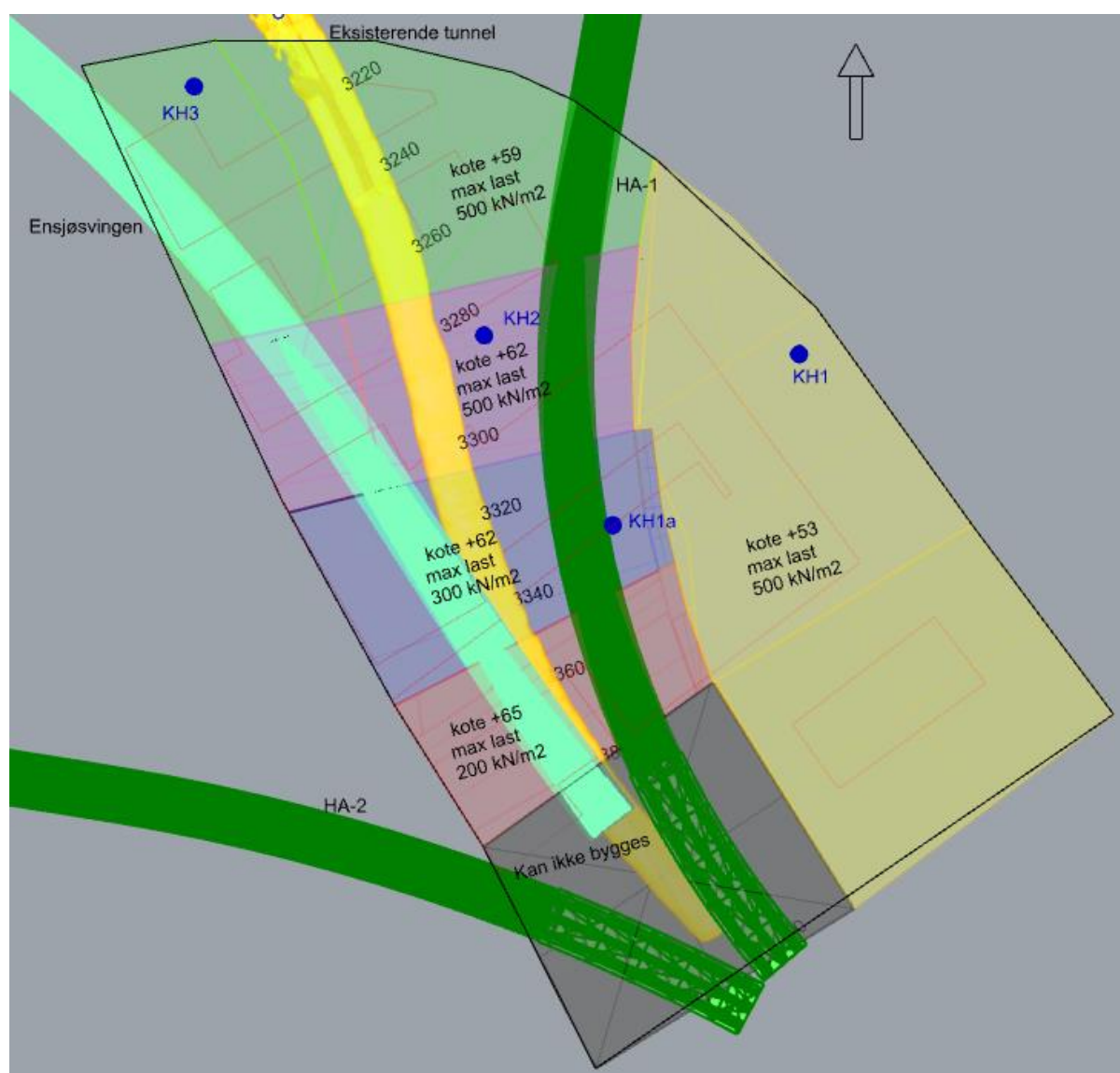
Figur 6: Utklipp av modell som viser anbefalt bergtaksplan på ny bebyggelse. Med «Kan ikke bygges» menes «kan bygges samtidig som utbygging av ny tunnel».
