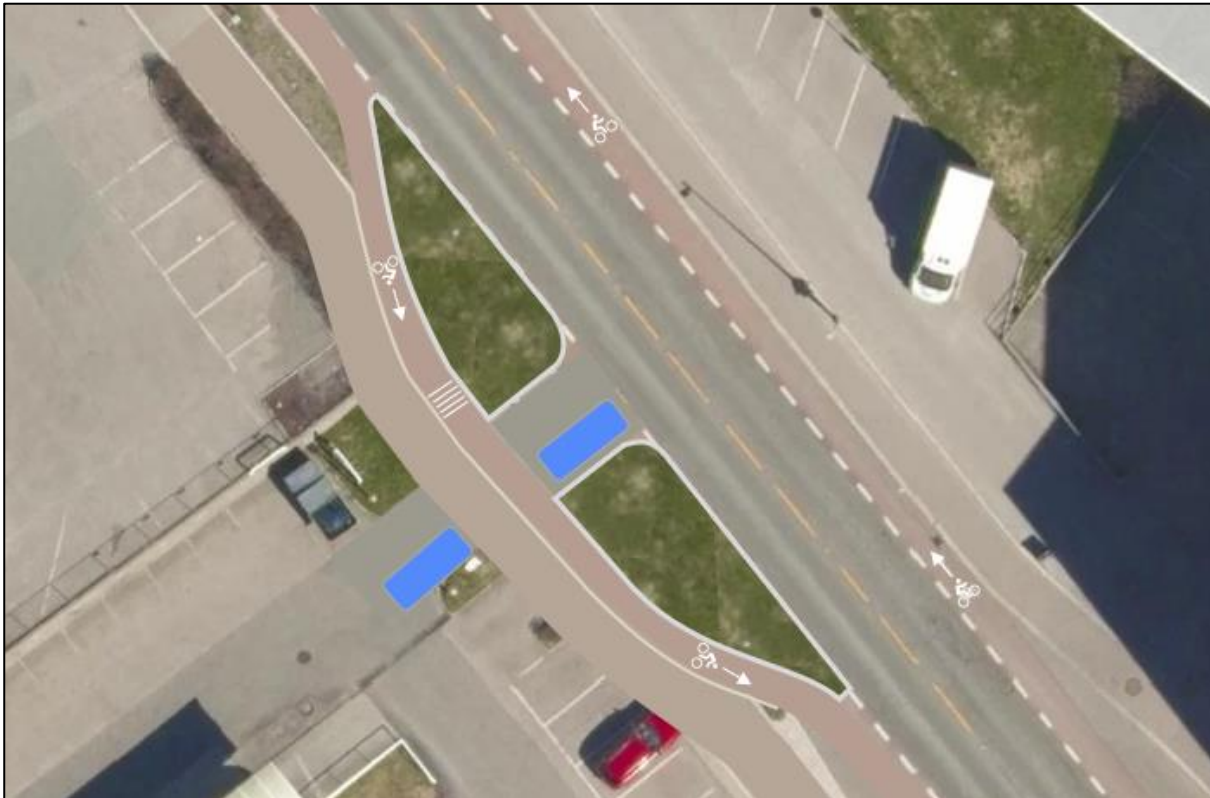
Figur 9.5: Utformingsprinsipp for tilbaketrukket sykkelfelt i avkjørsler (Kilde: Sweco Norge AS)
