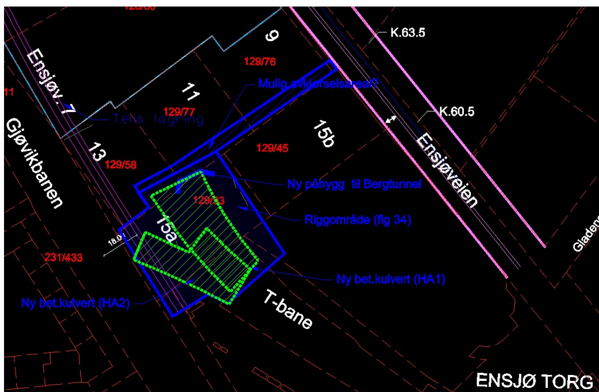
Bilde 9 – Ensjøveien 15 A - riggområdet for Ruter ved en ev. fremtidig utbygging av T-banetunneler.
