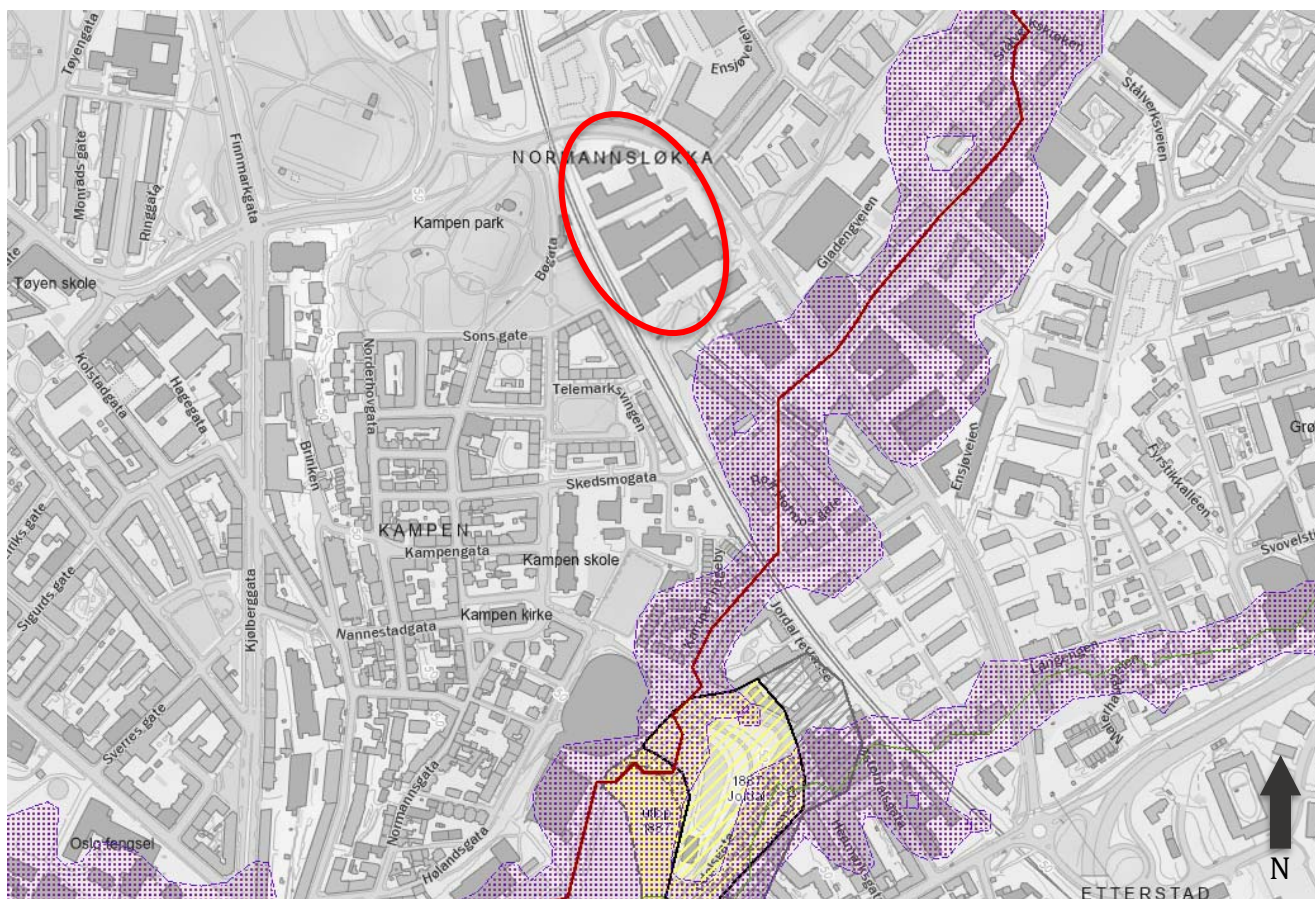
> Figur 6: Utsnitt fra NVE Atlas, som viser aktsomhetsområder for flom og registrerte faresoner for skred. Planområdet i rødt
