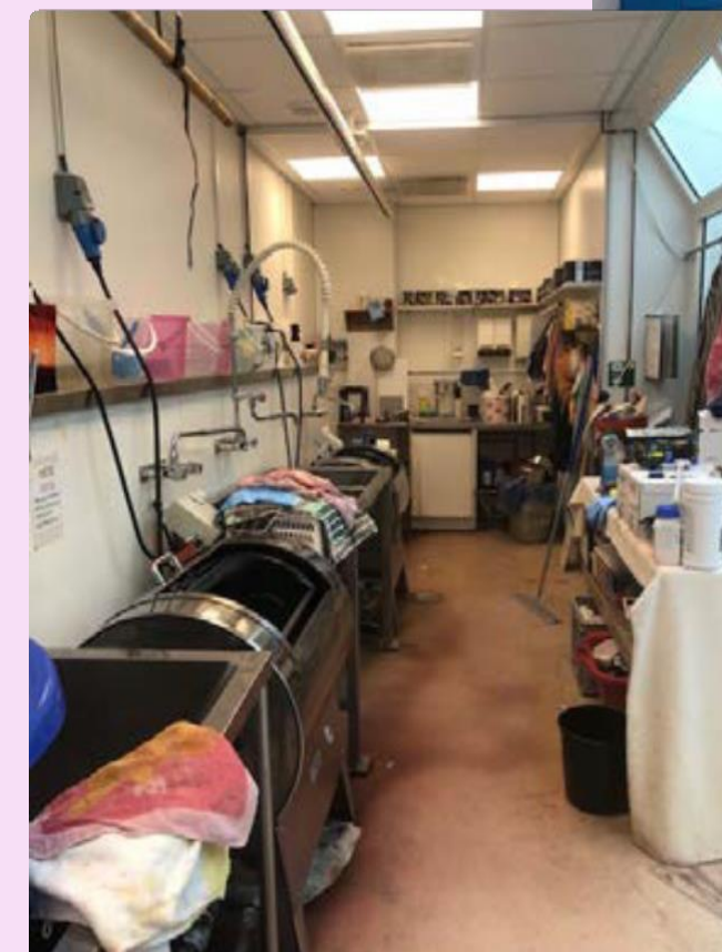
Kostymer behandles med spraymaling og liming, og det kan være arbeid som krever metallsliping. Videre er det vaskeri og fargerier for tekstiler. For å få dette verkstedet til å fungere i daglig drift stilles det krav både til sikkerhet, ekstra ventilasjon, brannforskrifter og våtromsnorm.(Foto: Christina Espedal)
