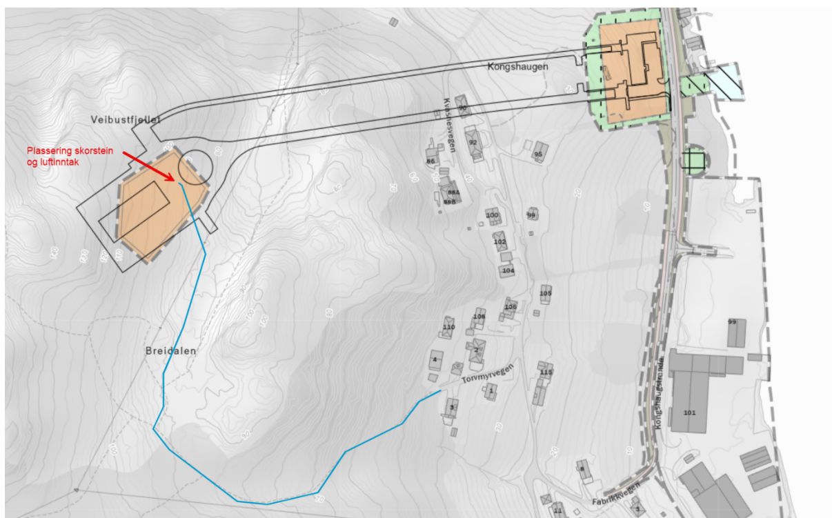
Figur 5 – Traktorveg og kjørespør for tilkomst til tomt for skorstein og luftavkast
