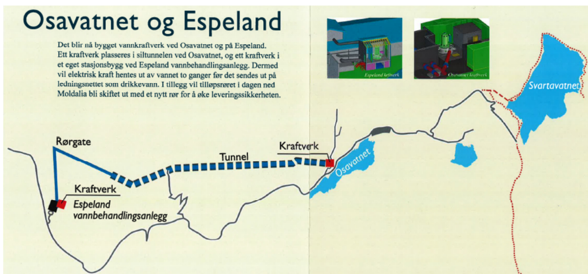
Figur 1: Oversiktsfigur Osavatn og Espeland kraftverk i vannverk (utklipp fra Bergen Kommunes informasjonsbrosjyre)
