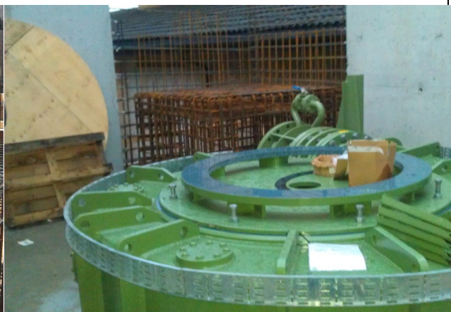
Bilde 32 – Espeland, turbin før innmotasje
