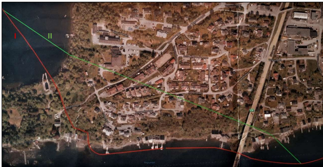
Figur 1. Kart fra oppdragsgiver som viser to mulige alternativer (I og II) for ny avløpsledning til Kvasnes.
