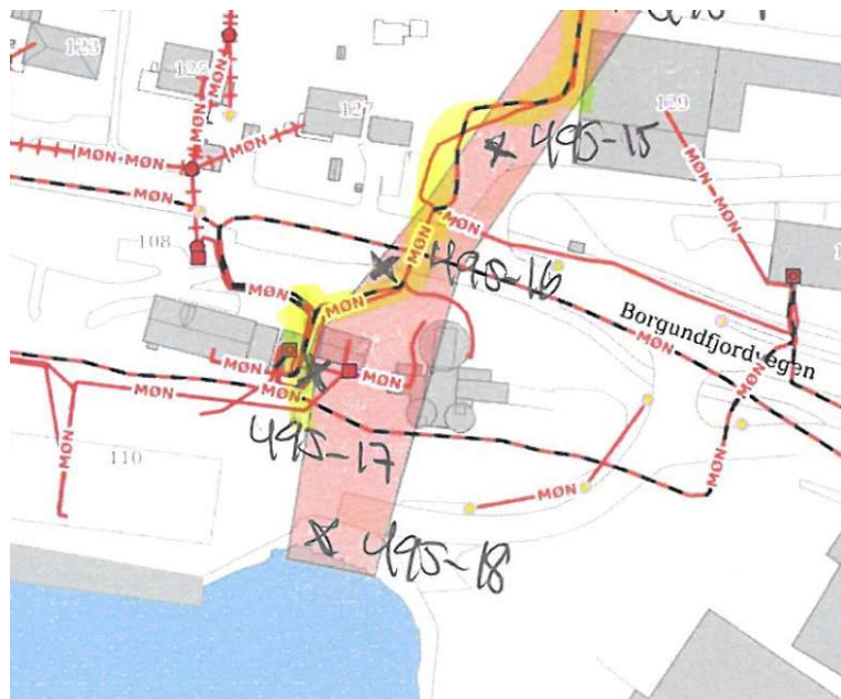
Figur 5-2 Utklipp fra kabelkart fra Mørenett AS. Lavspennet og høyspentledning ligger innenfor planlagt utgravningsområde
