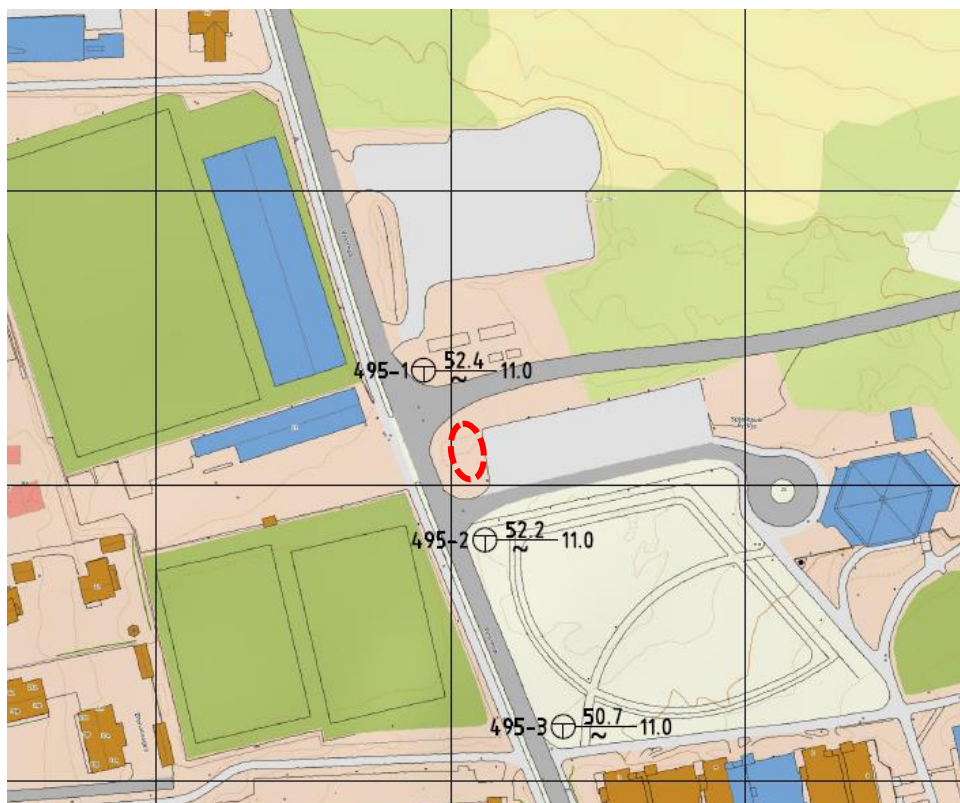
Figur 3-2 Utklipp fra borplan i rapport 10243684-RIG-RAP-493-001 [3]. Omtrentlig plassering av byggegrupp for ventilhuset, er vist med rød ellipse. Det ble utført prøvetaking i BP 495-2 og 495-3, som ikke kommer frem av borplan.
