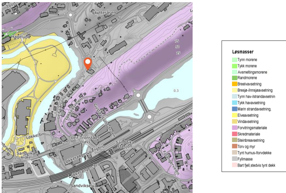
Figur 5: Utsnitt fra NGUs løsmassekart viser at massene består fyllmasser.
