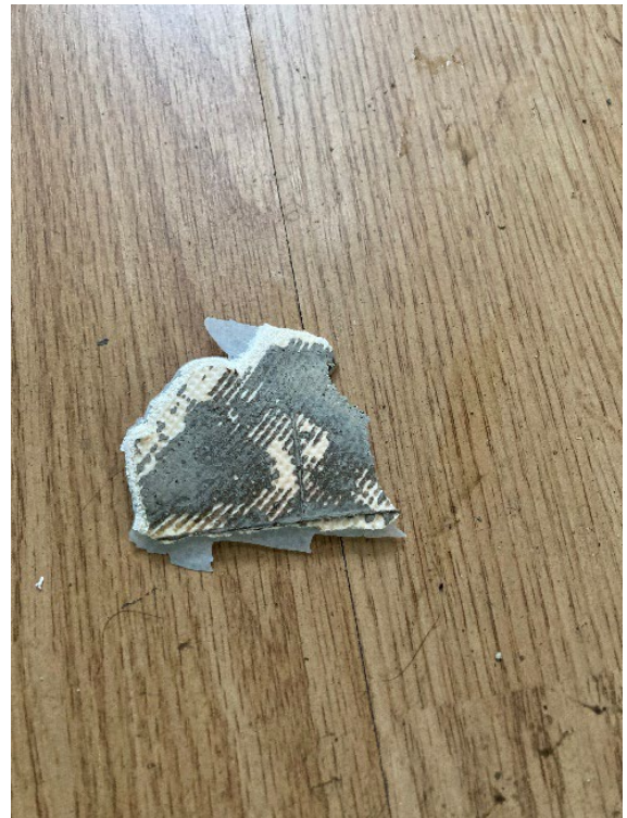
Figur 2: Lim under beige vinylbelegg (K1b) ble prøvetatt i rom K1 i kjeller. Det ble ikke påvist asbest i prøven.
