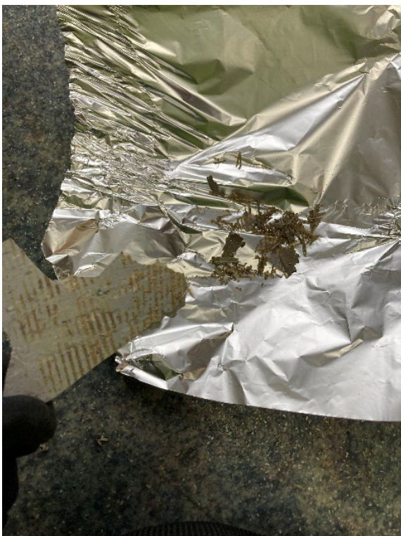
Figur 9: Lim under lysebrunt vinylbelegg (E1.2) ble prøvetatt i rom E1.2 i etasje 1. Det ble ikke påvist asbest i prøven.
