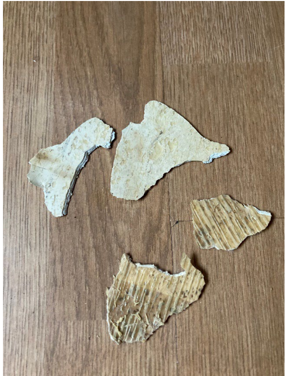
Figur 11: Hvit/beige vinylbelegg (E1.7a), prikkete brunt vinylbelegg (E1.7b) og gult lim (E1.7c) over prikkete brunt vinylbelegg ble prøvetatt i rom E1.7 i etasje 1. Det ble ikke påvist asbest i prøvene.
