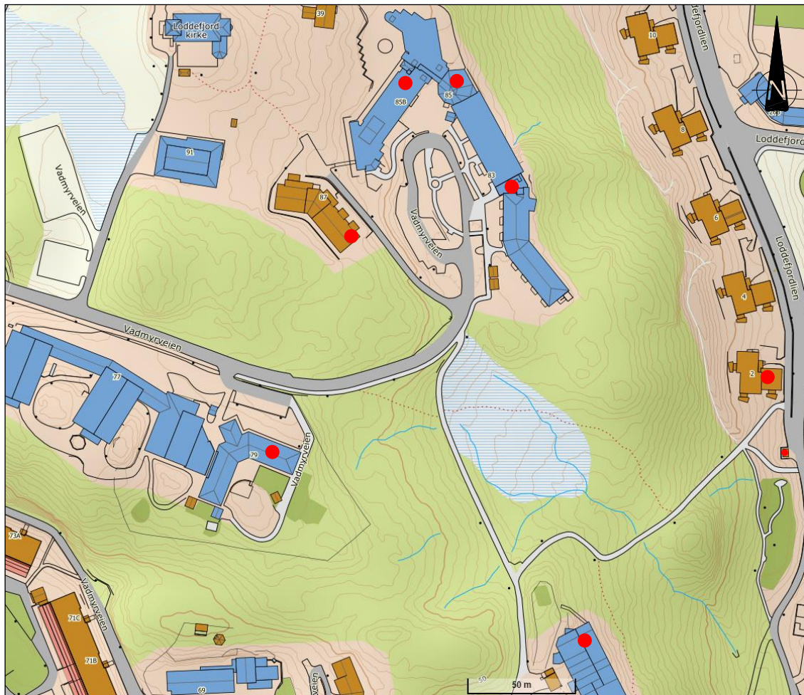
Figur 4-1: Markering av aktuelle bygg (rød sirkel) som det er vurdert vibrasjonsgrenser for i forbindelse med planlagte sprengningsarbeider langs Vadmyrveien.
