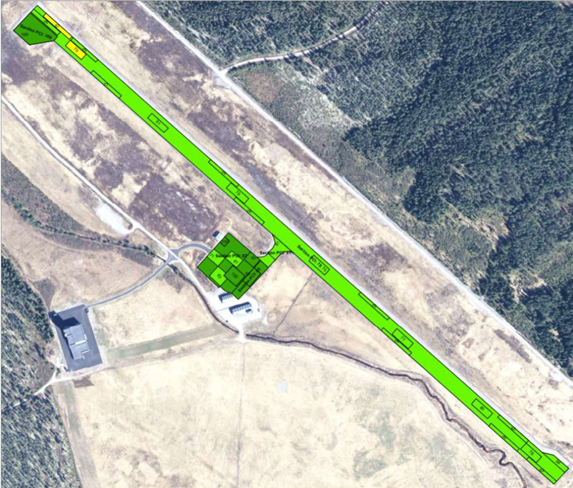
Bilde 5 Viser PCI for faste dekke pr. september 2022 (Ref. Sweco Vedlegg 2)
