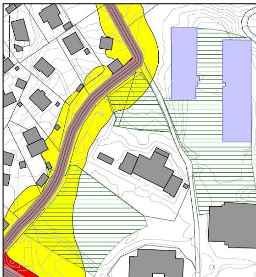
Støyberegning år 2030 uten skjerming, 1,5 m over terreng. De stiplede arealene er uteoppholdsarealer. Det minste er friområde o_GF.
