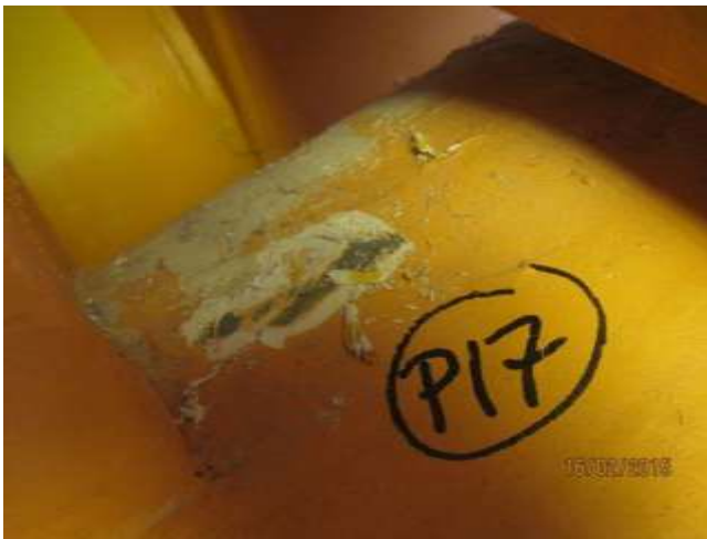
Bilde 18: Prøve 17 Sparkel på kanaler. Ikke påvist asbest
