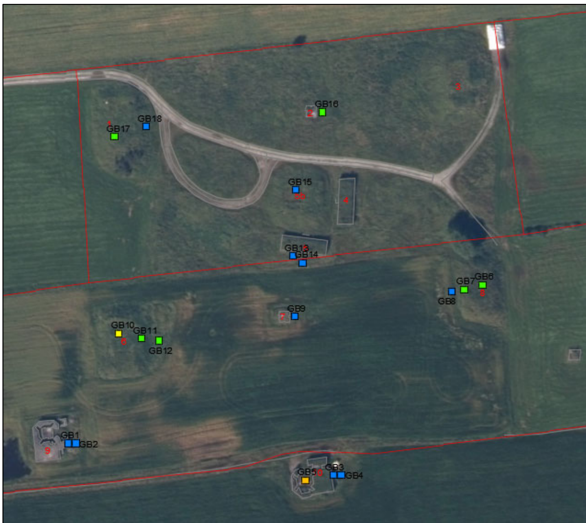
Figur 13 Situasjonsplan for området. Prøvepunktene er farget med høyeste påviste tilstandsklasse jf. Miljødirektoratets veileder for forurenset grunn med lokal tilpasning for krom og nikkel iht. Trondheim kommunes faktaark nr. 63. Blå = tilstandsklasse 1 (rene masser), grønn = tilstandsklasse 2, gul = tilstandsklasse 3 og oransje = tilstandsklasse 4.
