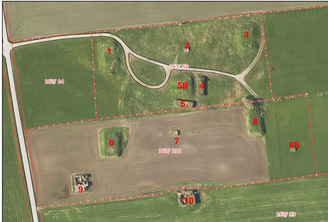
Figur 2 Flyfoto over området fra 2017. I flyfotoet er de forskjellige konstruksjonen nummerert. Nr. 1, 3, 5B, 6 og 8: gressdekt kanonstilling, nr. 2, 7 og 8B: lyskasterfundament, nr. 4 og 5: bunker og nr. 9 og 10: kanonstilling. Kilde: Ørland kommunes karttjeneste.
