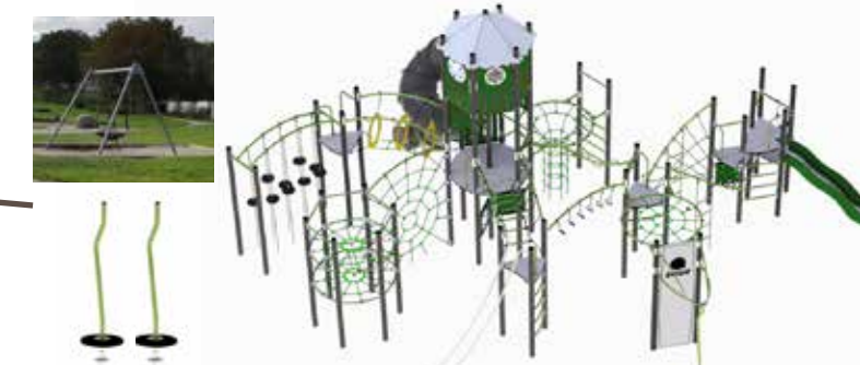
Hovedlekesone med Cerium lekesentral, to spinnerkaruseller i flisunderlag og relokalisert fugleredehuske i fallgummi. Nedsenka kanter med gummirampe for god fremkommelighet til flisbassenget. Illustrasjoner: Søve AS
