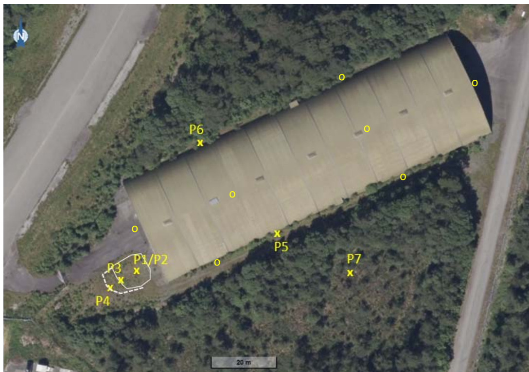
Figur 6: Forslag til plassering av supplerende prøvepunkter (vist med o). Plassering av prøvepunktene undersøkt i 2023 (P1–P7) er vist med x. I de supplerende prøvepunktene tas det prøver av både overflatenære masser (<1 m) og av dypereliggende masser (>1 m). I prøvepunktene som tidligere er undersøkt tas supplerende prøver av massene dypere enn 0,3 m. I alle prøvepunktene tas det prøver av massene ned til til planlagt gravedybde, til antatt rene stedegne masser eller til berg, avhengig av hva som påtreffes først. Foto: www.norgeskart.no .
