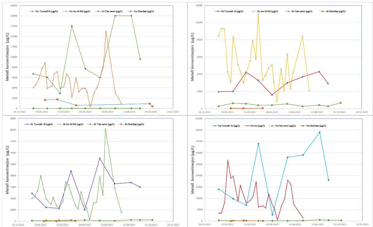
Figur 11 Cu, Zn, Al og Fe konsentrasjon for tunnelvann, overløp, takvann og innløp til dagens Killingdal RA
