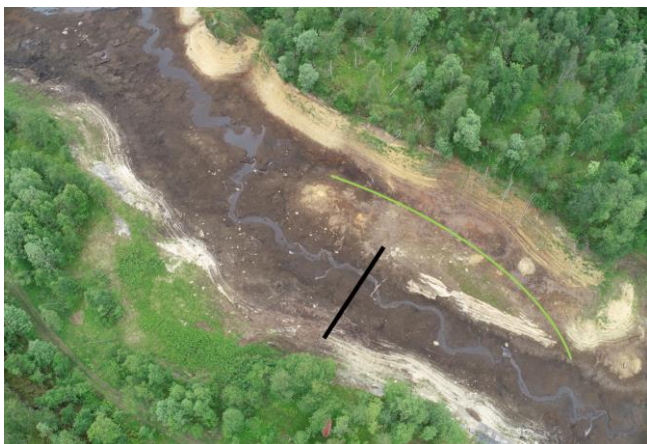
Figur 6 Viser omtrentlig plassering av løsmasseterskel (svart linje) og flomløp (grønn linje). Vannspeilet i søndre Mølnrotjern vil heves vesentlig sammenlignet med nivået i dette bilde.
