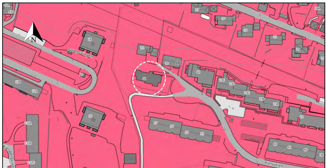
Figur 4. Berggrunnskart. Hvitstiplet ring angir omtrentlig plassering av tiltaksområdet. Rød farge indikerer at berggrunnen består av granitt. Kilde: NGUs kart på nett [6].
