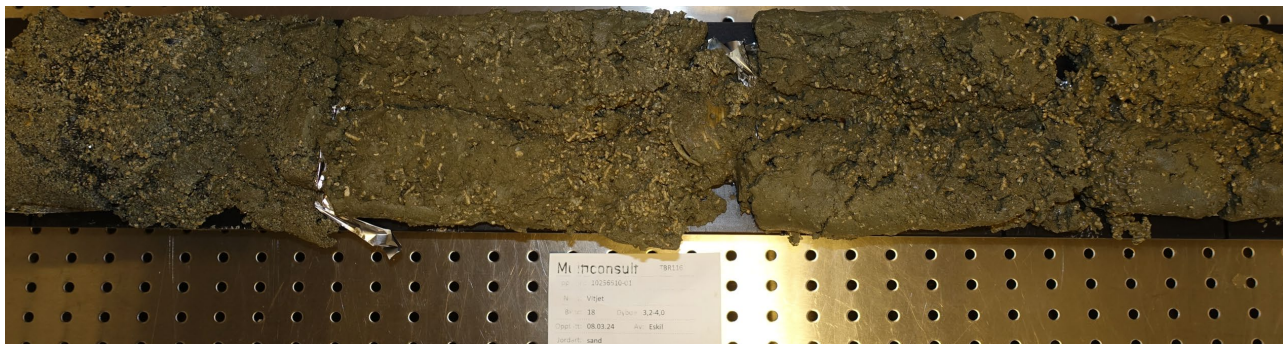
Figur 4-6: Sylinderprøve med korallsand som inneholder store skjellfragmenter lokalt i prøven. Fra borpunkt 18 ved Vedøyskallen ved dybde 7,2-8,0 m.
