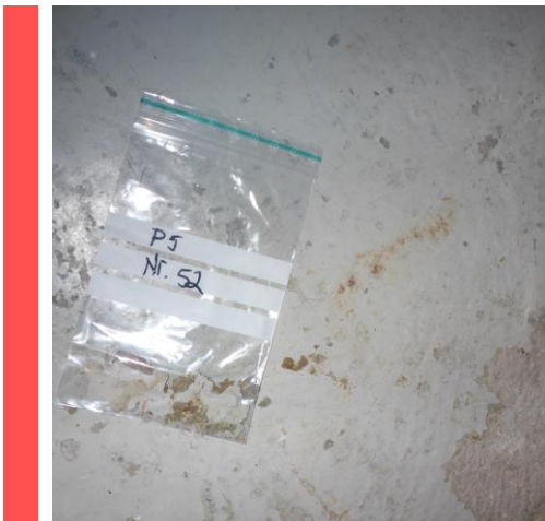
Figur 19 Gulvmaling (P5), rom 002, inneholder bly og sink over grensen for farlig avfall.
