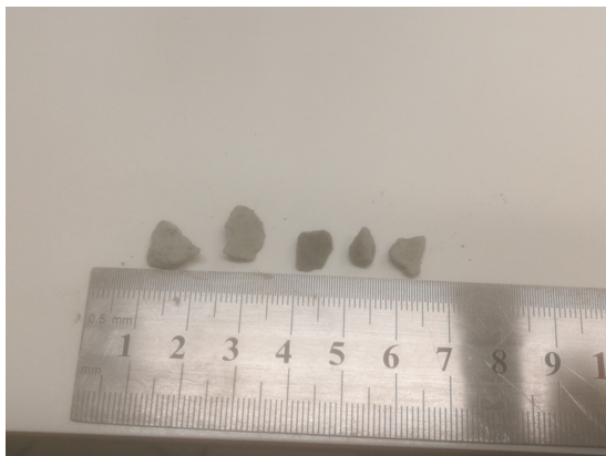
Fjernet gruskorn fra prøven før konusforsøk
