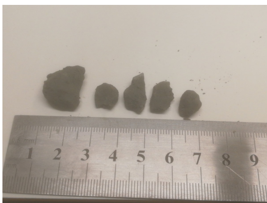
Fjernet gruskorn fra prøven før konusforsøk
