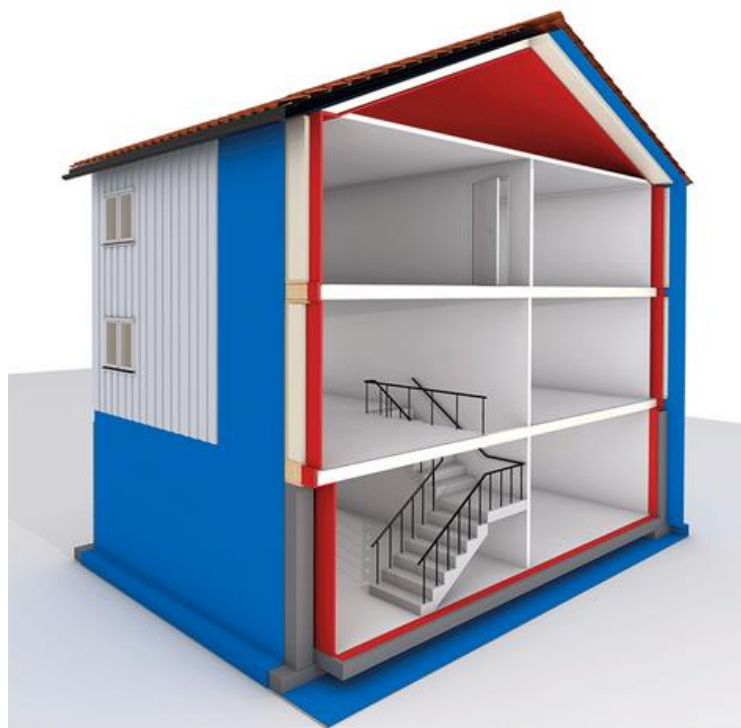
Figur 8-1 Eksempel på kontinuerlig sperresjikt i klimaskjerm. Blå farge viser vindsperresjiktet og rød farge viser dampspersjiktet. Figur i BKS 520.401.
