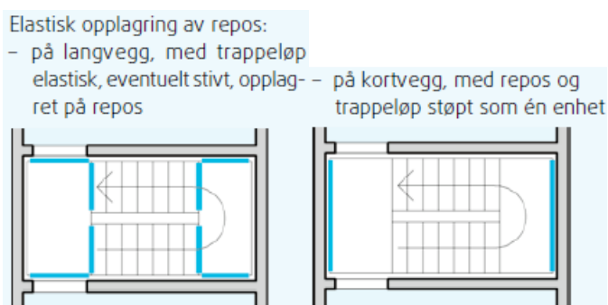
Figur 1 Elastisk opplagring av repos (kilde: Byggdetaljblad 532.241).
