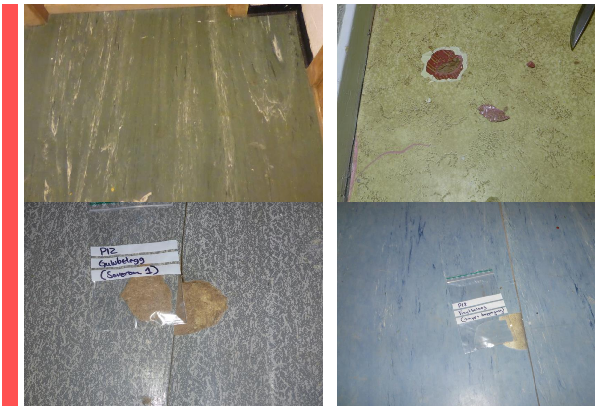
Figur 12 Ulike typer vinylbelegg som inneholder ftalater over grensen for farlig avfall.
