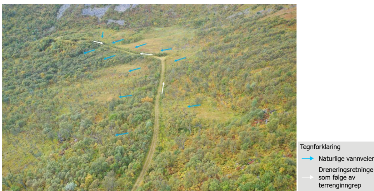
Figur 5-48: Viser vannretninger i område vei nord. Angitte vannretninger er forenklet og baserer seg på digital terrengmodell og modellering i ArcGIS Pro. Dronebildet er tatt fra øst mot vest, september 2023.
