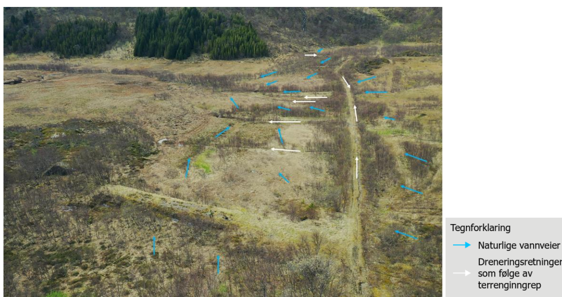
Figur 5-6: Viser vannretninger i område C2. Angitte vannretninger er forenklet og baserer seg på digital terrengmodell og modellering i ArcGIS Pro. Dronebilde er tatt fra øst mot vest, mai 2023.
