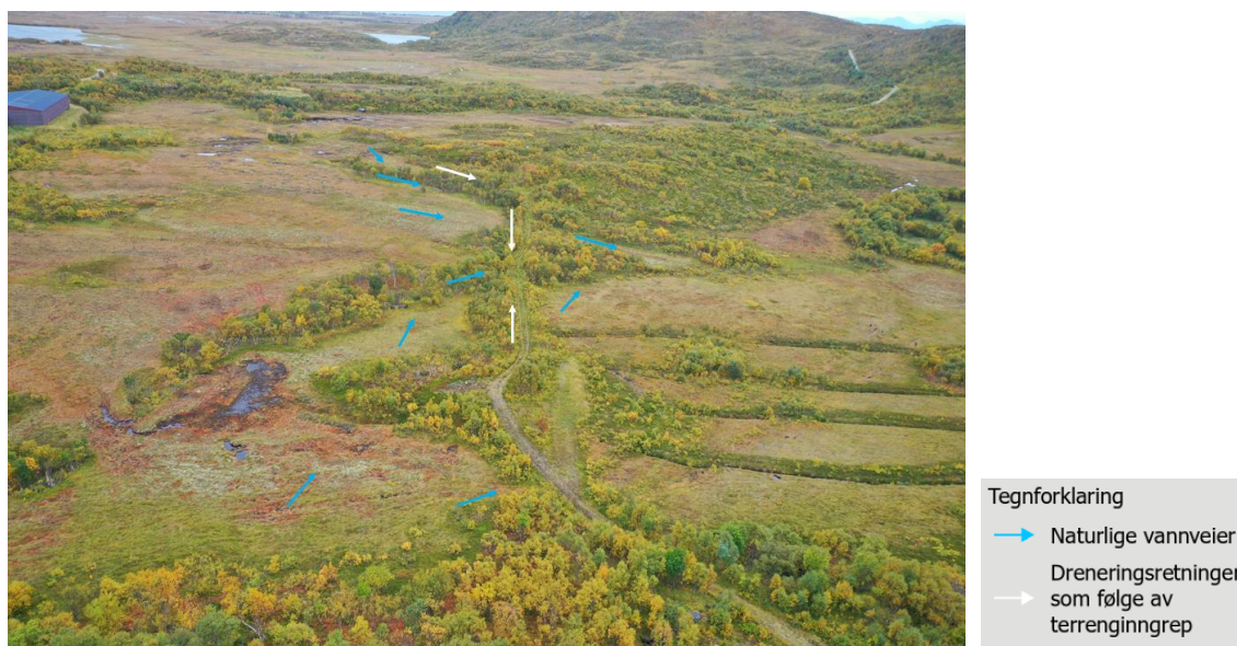
Figur 5-43: Viser vannretninger i område vei D1/D2. Angitte vannretninger er forenklet og baserer seg på digital terrengmodell og modellering i ArcGis Pro. Dronebildet er tatt fra nord mot sør, september 2023.
