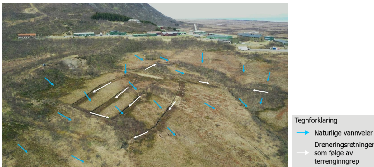
Figur 5-36: Viser vannretninger i område D1/D2. Angitte vannretninger er forenklet og baserer seg på digital terrengmodell og modellering i ArcGis Pro. Dronebildet er tatt fra sørvest mot nordøst, mai 2023.
