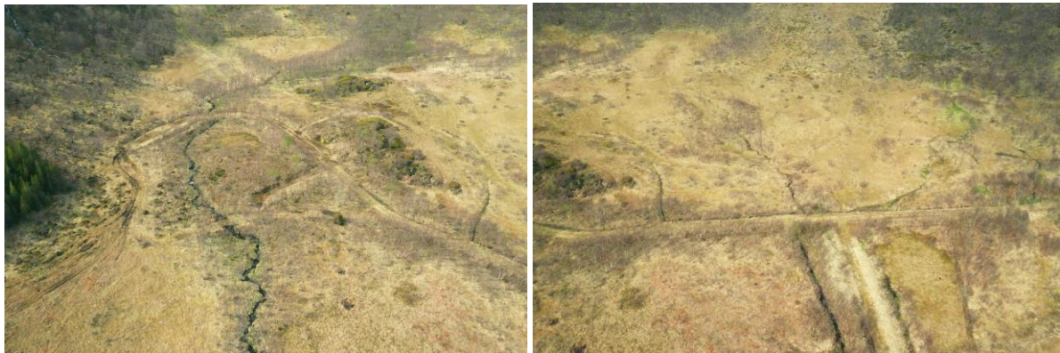
Figur 5-10: Dronefoto av område C2 i vest (til venstre) og øst (til høyre). Dronefotoet viser naturlige bekkeløp som er berørt av vei og langsgående dreneringsgrøft. Daleelva vises midt i bildet til venstre.
