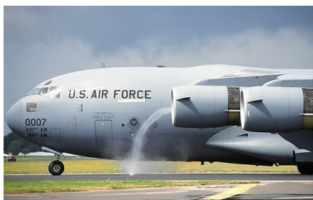
Bildene over viser noe som kalles engine inlet vortex, og illustrerer på en god måte hvordan luft suges inn i motorene.
