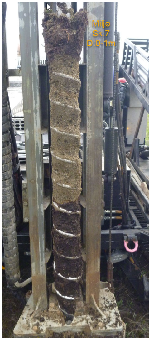
Figur 4-7: Bilder fra miljøprøvetakingen. Skoveprøve 7. Dybde 0-1m. Massene består øverst av et torvlag på ca. 10 cm. Underliggende masser er antatt grusig sand før torv påtreffes ved ca. 0,6m dybde.
