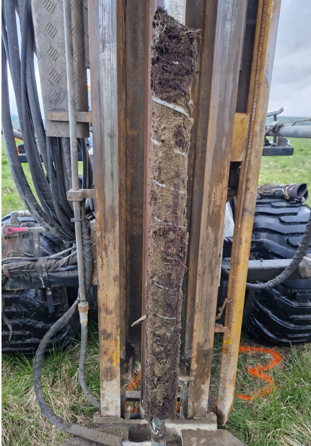
Figur 4-3: Bilde fra skovlprøvetaking ved borpunkt 3, dybde 0-1m. Øvre 10 cm er torv. Underliggende masser er sandig, grusig, siltig materiale og fra ca. 0,3-0,9m er massene torv.
