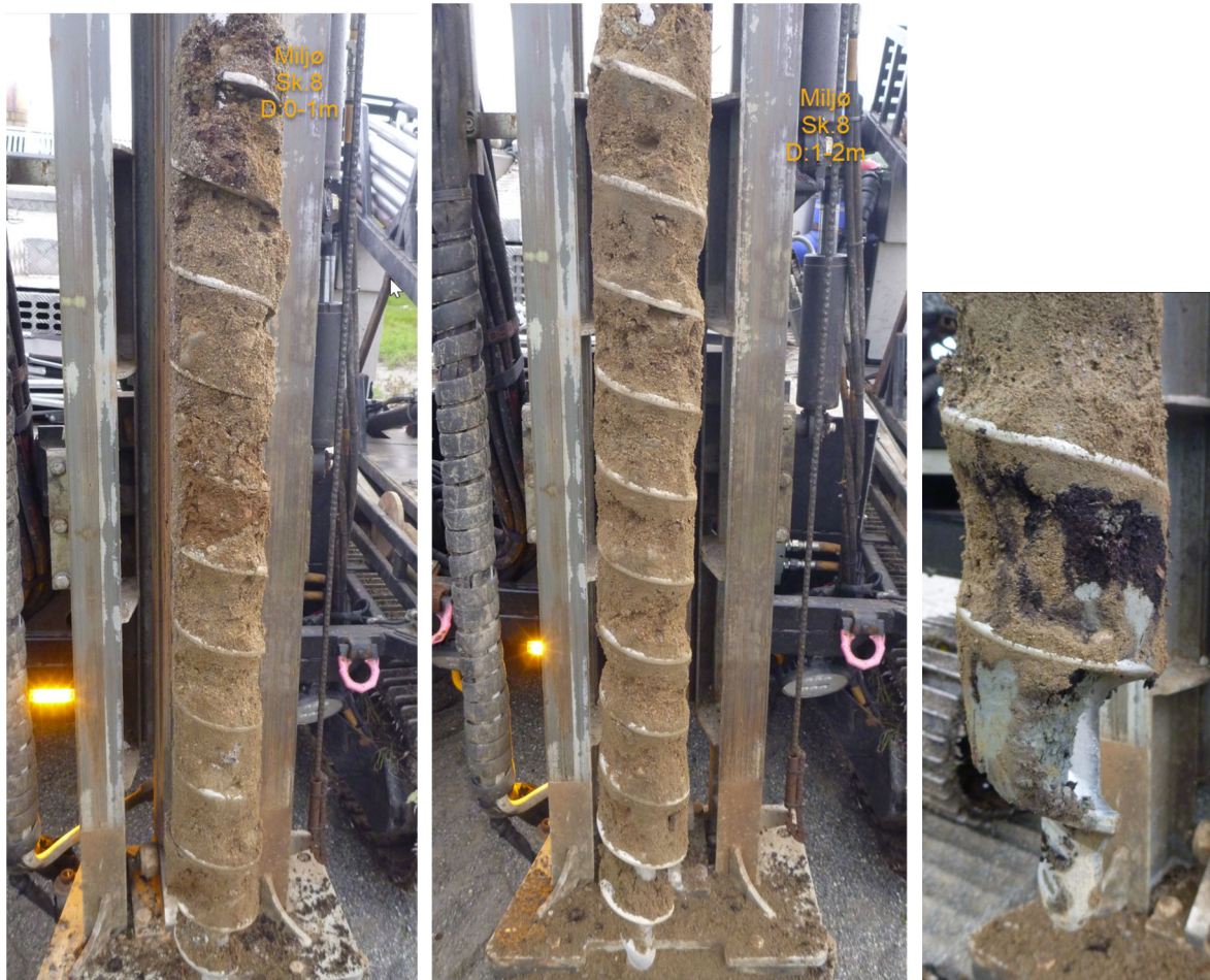
Figur 4-8: Bilder fra miljøprøvetakingen. Skoveprøve 8. Dybde 0-1m (t.v.), 1-2m (midten) og 1,8-2,0m (t.h). Massene består øverst av et torvlag på ca. 5 cm. Underliggende masser er antatt grusig sand. Ved ca. 1,9 m dybde påtreffes et tynt lag av torv over leirige masser.
