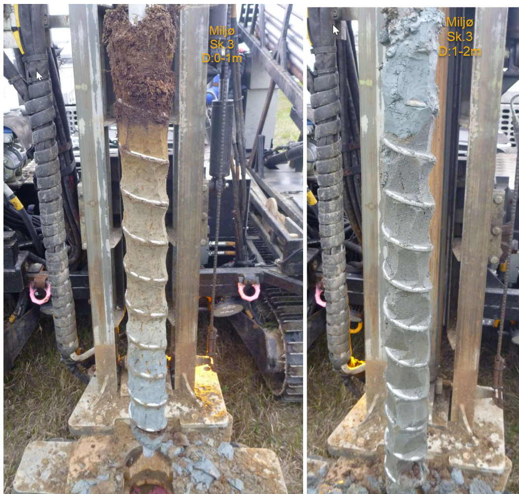
Figur 4-6: Bilder fra miljøprøvetakingen. Skoveprøve 3. Dybde 0-1m (t.v.) og 1-2m (t.h.). Massene består øverst av et torvlag på ca. 20 cm. Underliggende masser er sand/silt og et leirlag fra ca. 1-1,1m dybde.
