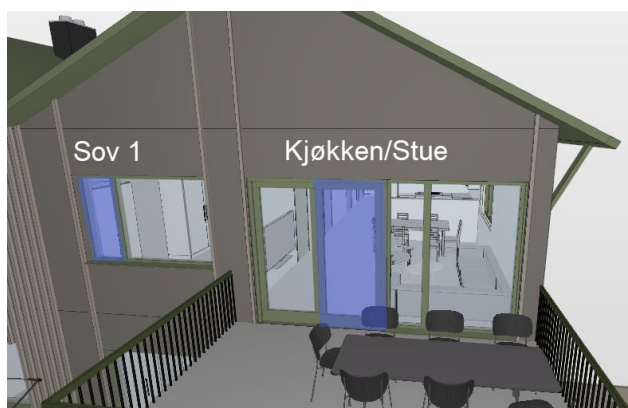
Figur 1: Nordfasade. Vindu og skyvedør markert med blått kan åpnes.
