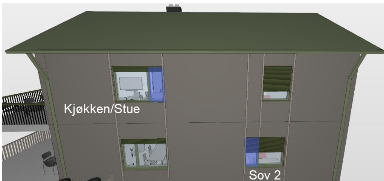
Figur 2: Vestfasade. Vindu markert med blått kan åpnes.
