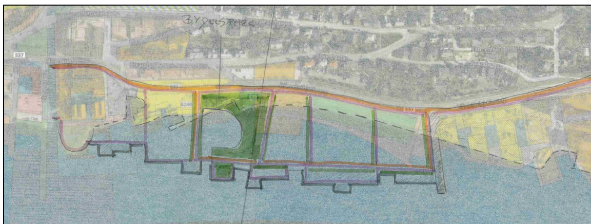
Bilde 8. Alternativ utfylling 3, med masser fra tunneløp 1 og 2. Mulig utfylling og bruk av områdene i Grandfjæra mot Brunvollkvartalet, gitt at fylkeskommunen har flyttet ferjekaia til Sekkenferja. Utfylling med masser fra tunneløp 2 mot Brunvollkvartalet er først aktuelt når årstdøgnetrafikken har passert 8000 gjennom de nye tunnelene i Molde, anslått til etter år 2050.
