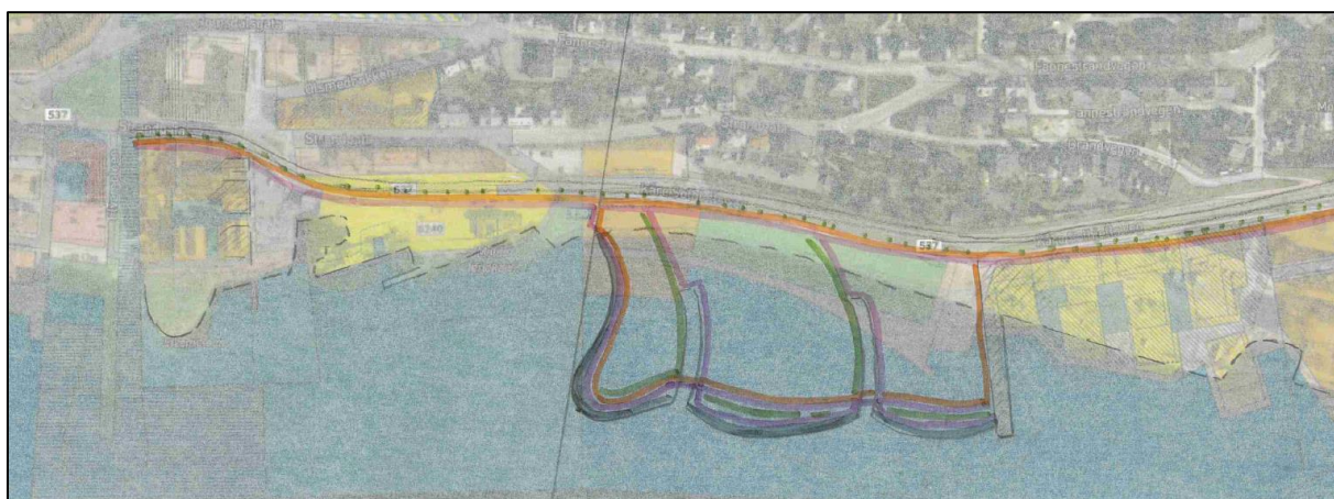
Bilde 5. Alternativ utfylling 2, med masser fra tunneløp 1.
