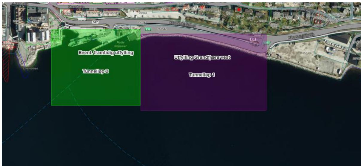
Bilde 2. Uttylling med masser fra hhv. tunnellop 1 i Grandfjæra vest og mulig uttylling med masser fra tunnellop 2 (anslått aktuelt tidligst 2050).
