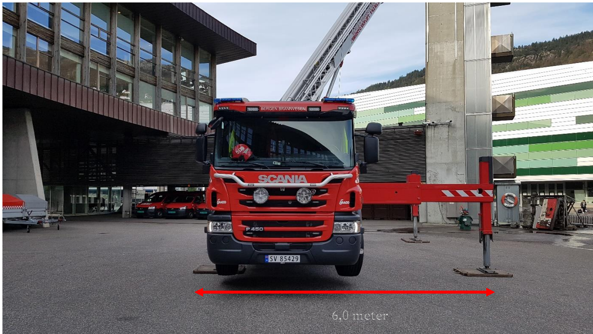
BILDE 2 TOTAL BREDDA PÅ BRANNBIL VED MINIMUM AV STØTTELABBER UTE
