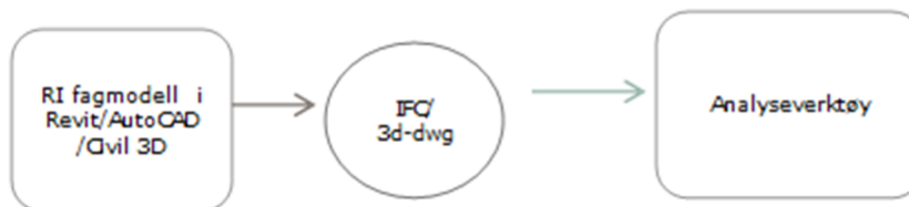
Figur 13 4.13 Deling av modeller fra Revit/AutoCAD/Civil 3D/Plant 3D til analyseverktøy
