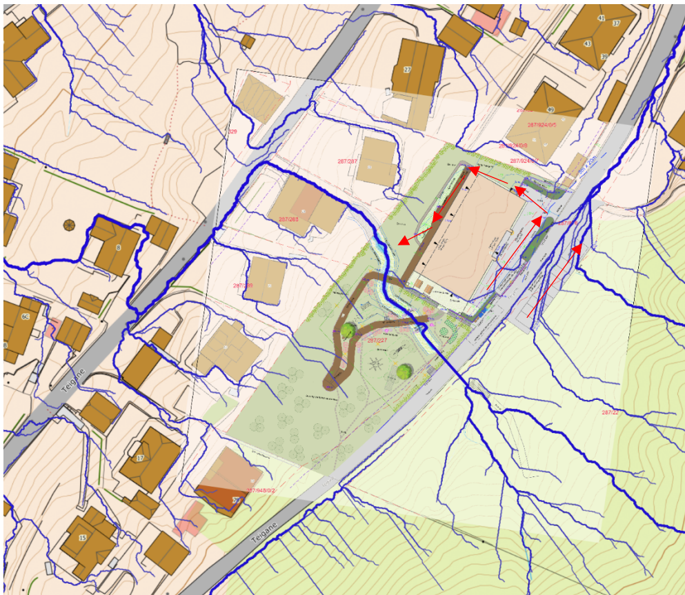
Figur 8-1 Avrenningslinjer planlagt situasjon, de røde pilene viser avrenningsretning i planlagt situasjon via sluk og fordrøyningsmagasin. Avrenningslinjen (blå) ved planlagt bygg viser avrenningsretning dersom sluk er ute av drift.
