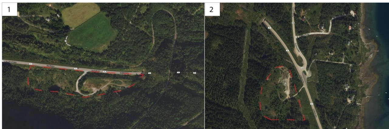
Figur 5: Massedeponier med steinmasser fra opprinnelig driving av tunnel. Rødt omriss viser den antatte utstrekningen av massene. 1) Vest for tunnel. 2) Øst for tunnel.
