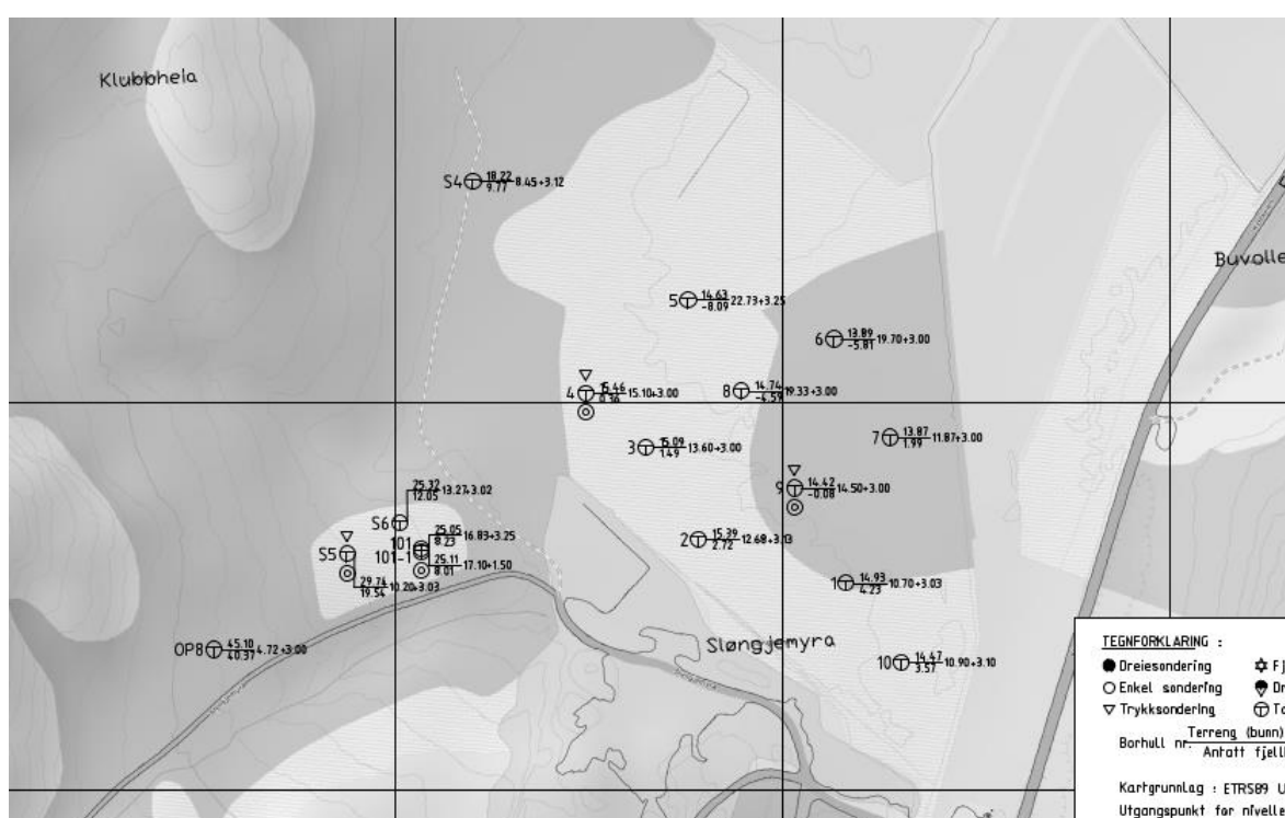
Figur 6. Boreplan over tidligere utførte grunnundersøkelser.
