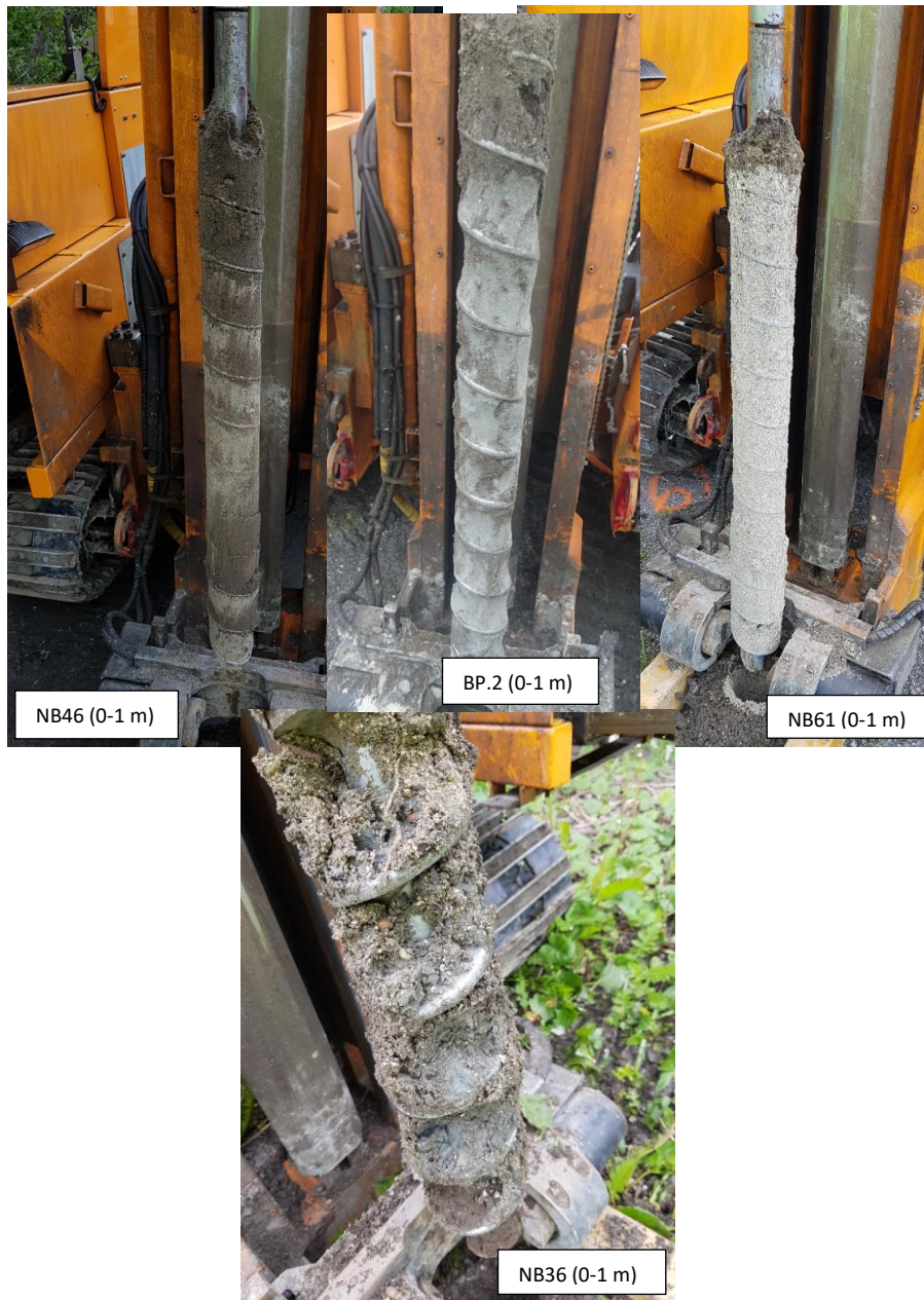
Figur 4-1: Bilder fra prøvetakingen med boreriggen, fra prøvepunkt: NB36, NB46, NB61 og BP.2.
