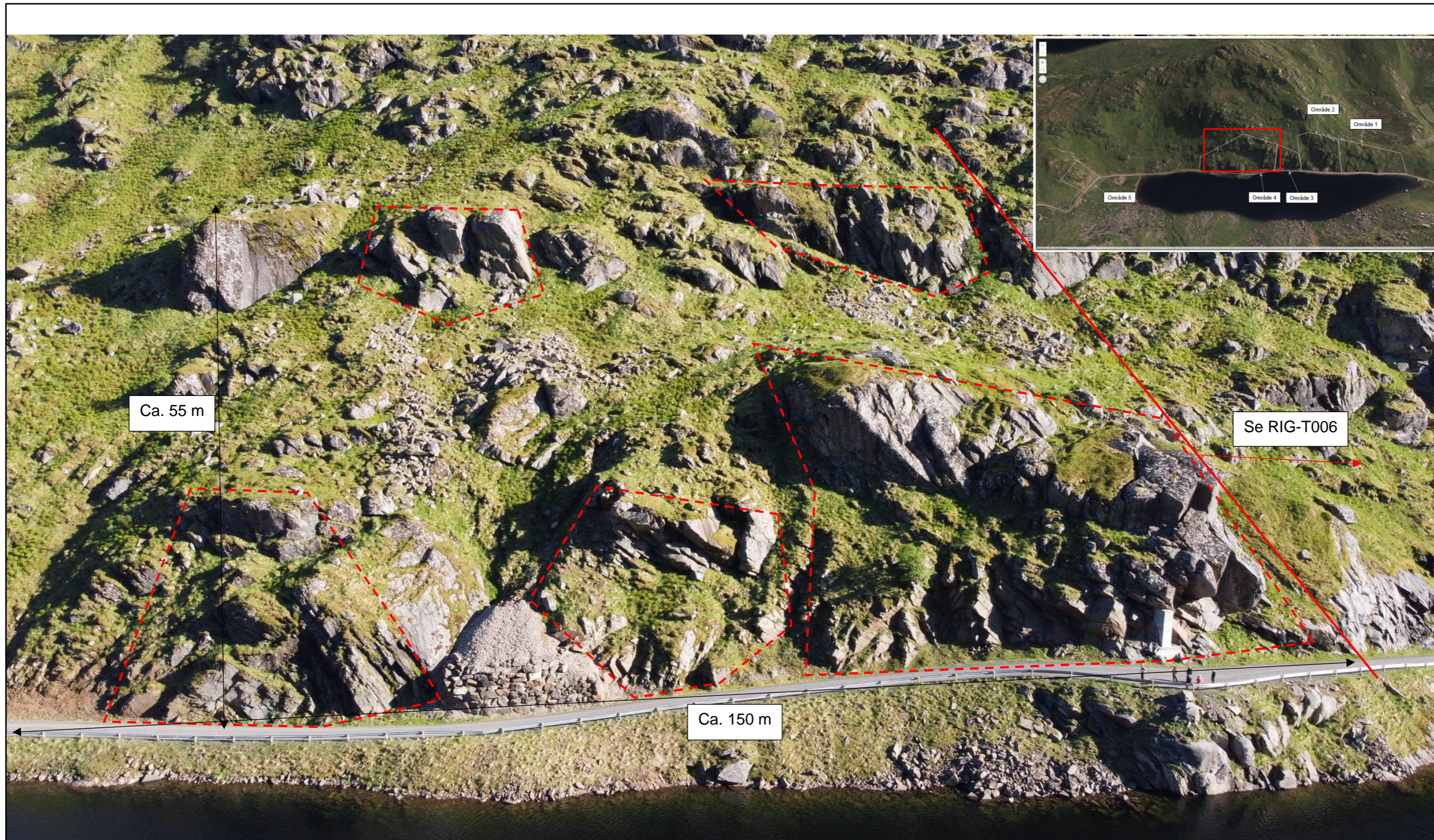
Område 4. Røde stiplede linjer viser omfang av rensk. I tillegg blir det behov for bolter og stag.
