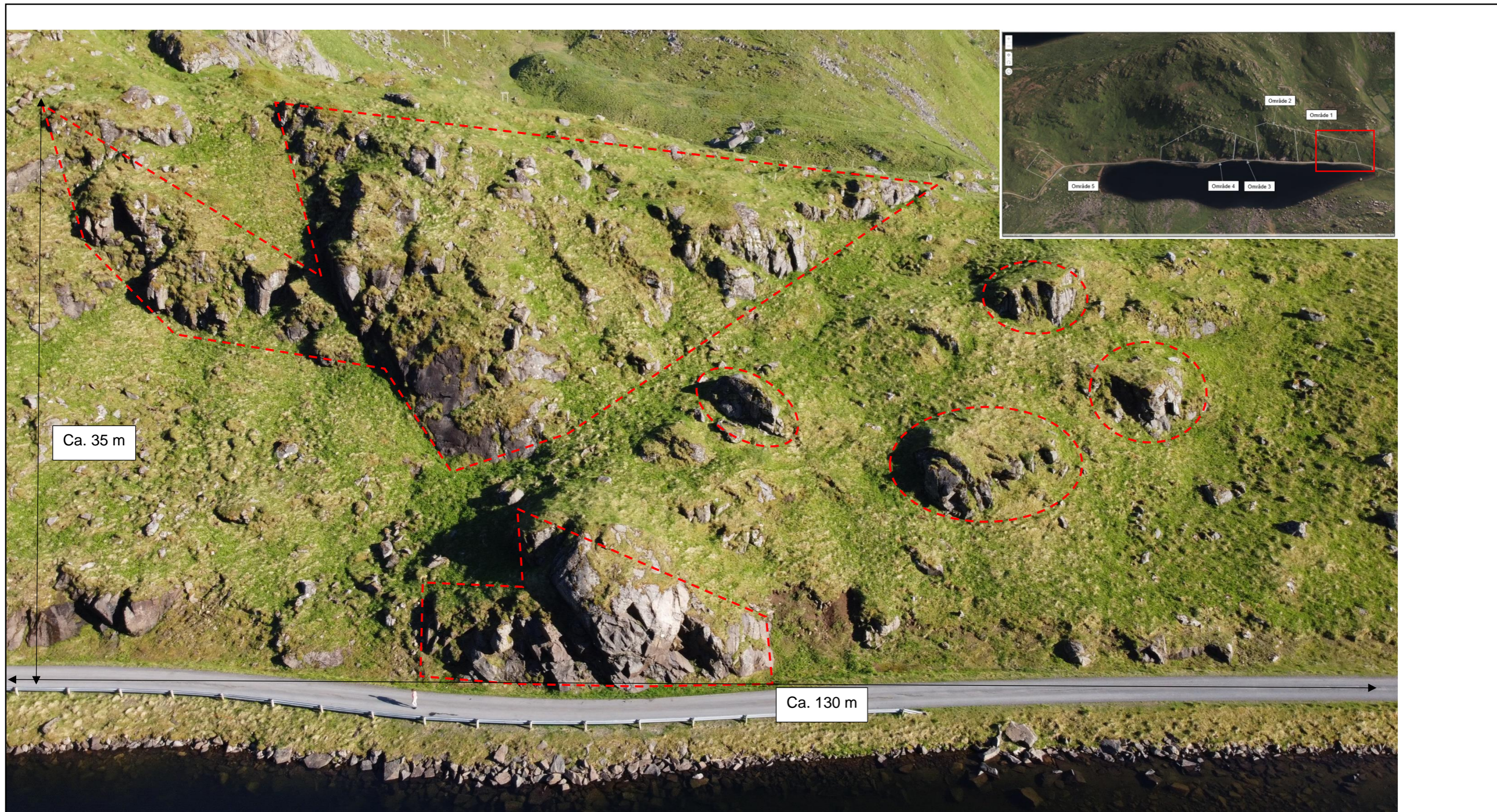
Område 1. Røde stiplede linjer viser omfang av rensk. I tillegg blir det behov for bolter og stag.
