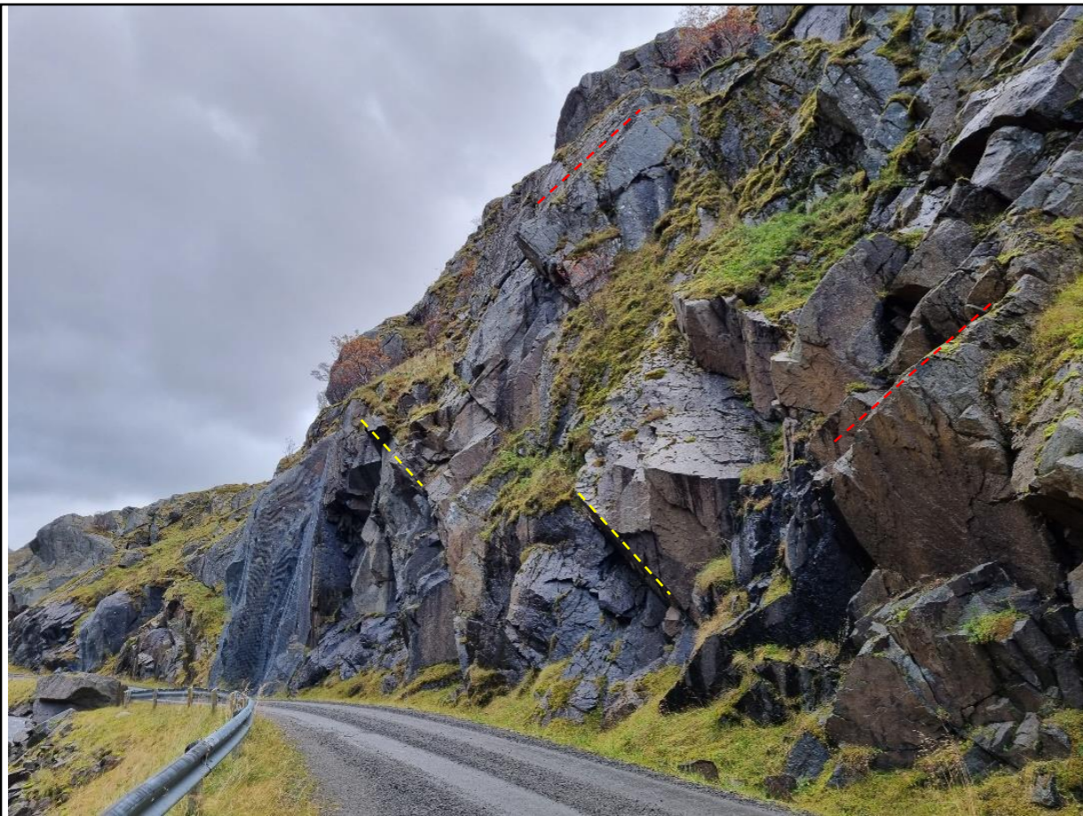
Gul stiptet linje viser sprekkesett 1 og rød stiptet linje visert sprekkesett 3.
