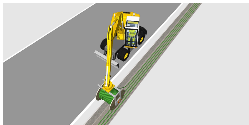
Figur 11: Utkjøring/ utrulling av kabel
