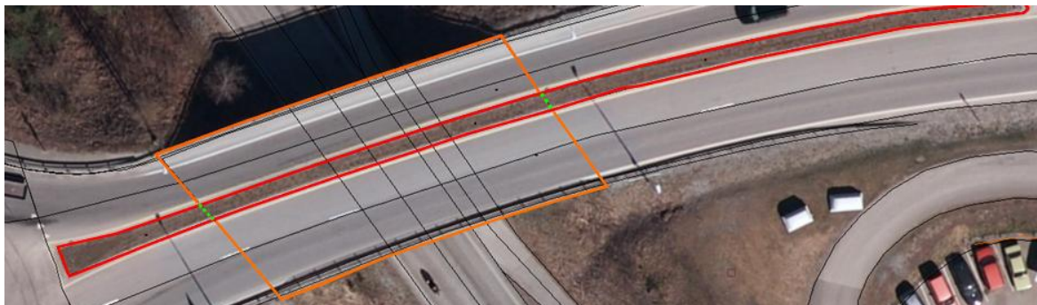
Figur 7. Eksempel på registrering av trafikkøye som delvis ligger på bru. Her er det benyttet VegFiktivGrense (grønn stiple) for å avgrense delen av trafikkøya som ligger oppe på brua (MEDIUM L) (Kilde: FKB Registreringsinstruks).
