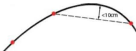
Figur 6. Pilhøyde på kurve med krumning
